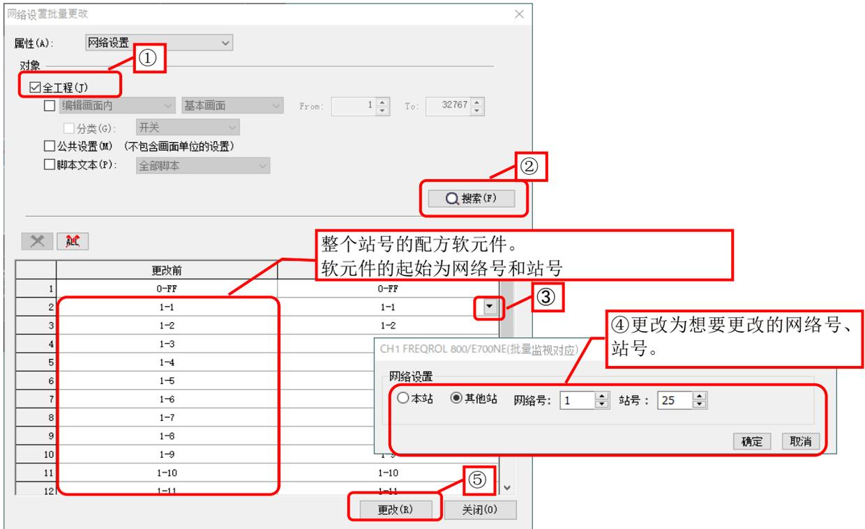
打开更改的站号用的配方设置的 [软元件] 选项卡，确认软元件已被更改。
